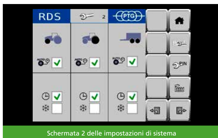
Avviso di scostamento di pressione per l'assale posteriore e possibilità di correzione
