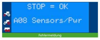
Um nach Behebung des Fehlers das Reifendruckregelsystem wieder vollständig zu benutzen muss aus-/eingeschaltet werden. Um den Fehler zu bestätigen muss die Bedienkonsole mittels Kippschalter aus-, und wieder eingeschaltet werden.
